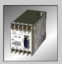
Le CPL48 est un transducteur entièrement configurable destinés à la mesure de réseau électrique équilibré. chaque sortie analogique est librement utilisable pour retransmettre l'une des 7 grandeur électrique mesurée.
